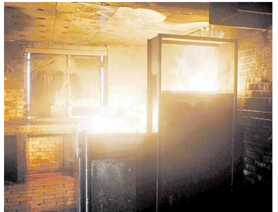
Mit Gas können in diesem Brandhaus gezielt Feuer entfacht werden.
